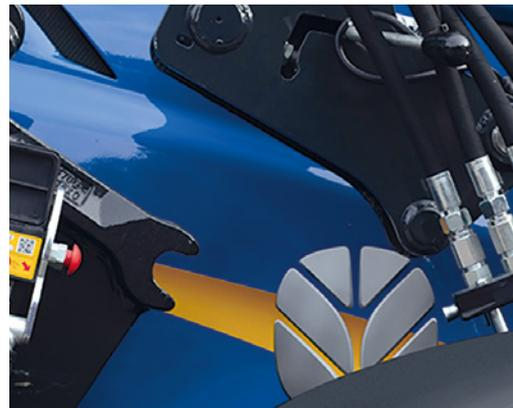
**1** Lors de l'attelage, le chargeur frontal glisse sur l'élément de montage jusqu'à ce que le boulon de blocage entre en contact avec la partie supérieure de la glissière.
