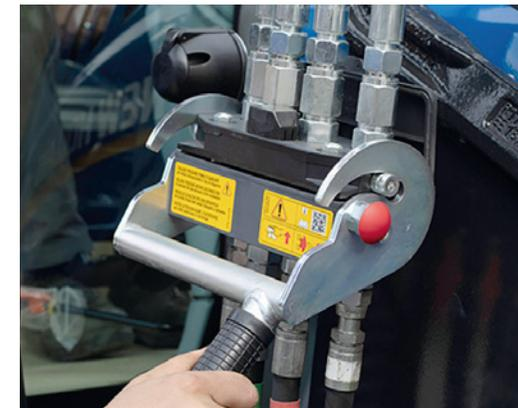
**2** Avec le dispositif Hydro-Fix, toutes les conduites hydrauliques peuvent être raccordées en une seule opération sur le tracteur. Le chargeur frontal peut être relevé en toute simplicité de façon à fixer le boulon de blocage dans le crochet d'arrêt de la glissière.
