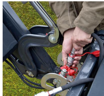
**3** Raccorder la connexion hydraulique.
