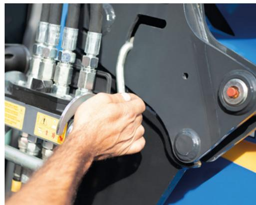
**3** Il suffit d'abaisser le levier de verrouillage pour fixer en toute sécurité le chargeur frontal sur l'élément de montage. Le chargeur frontal peut ensuite être relevé.
